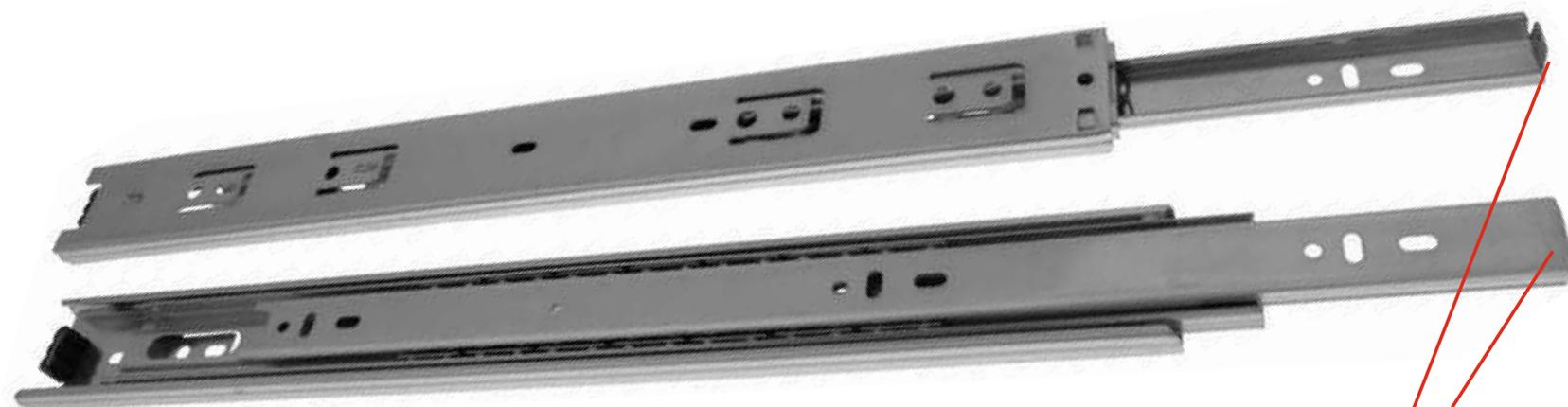
Для установки направляющих на корпус и боковины ящиков, необходимо вытянуть **узкую планку направляющей**, с обратной стороны надо поджать черный пластиковый флажок и можно вытягивать узкую деталь от направляющей.
