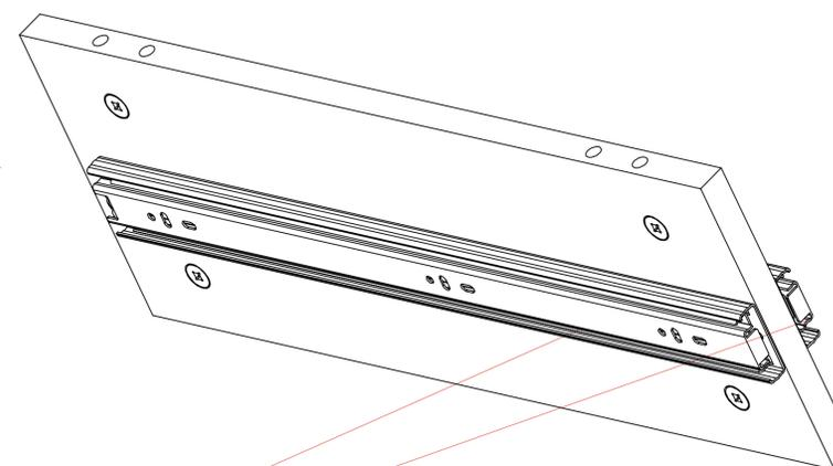
На центральных частях корпуса **направляющие** устанавливаются **с обеих сторон детали**
