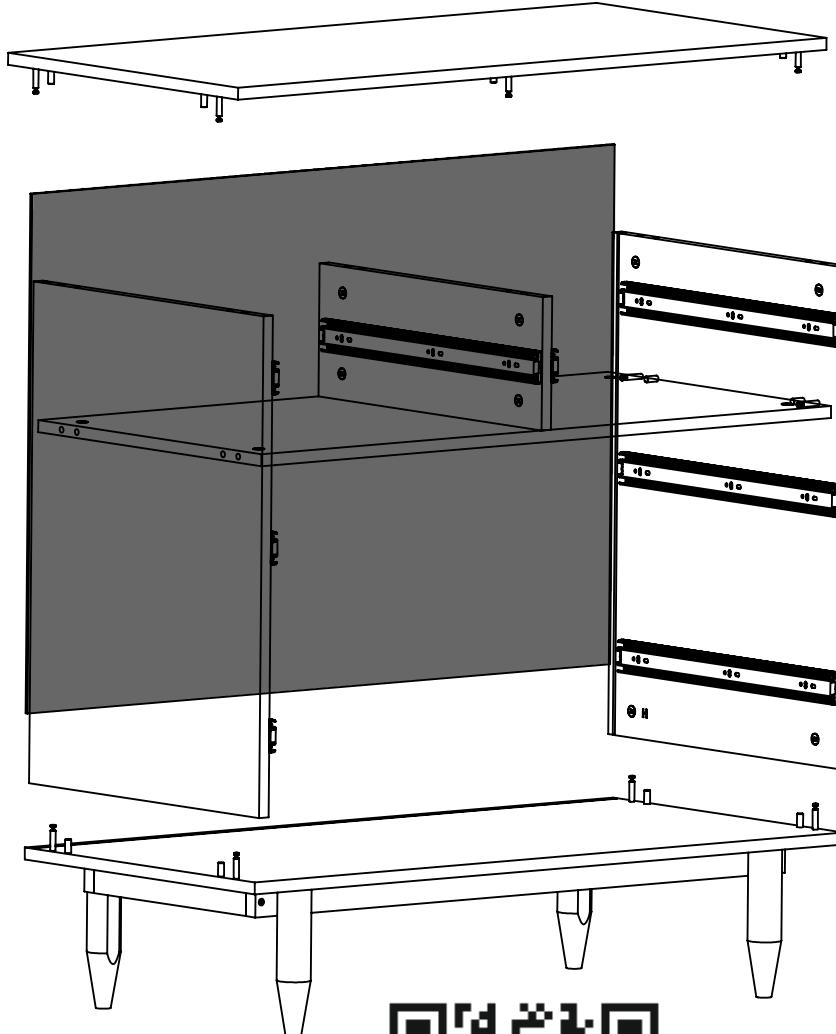
! Обязательно соблюдайте последовательность сборки в инструкции. Верхняя крышка корпуса устанавливается после монтажа задней стенки.
