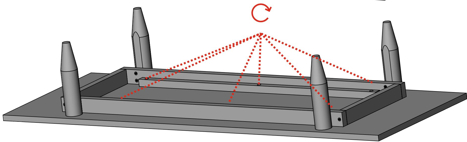
Корпус и ящики собираем на эксцентриковые стяжки
