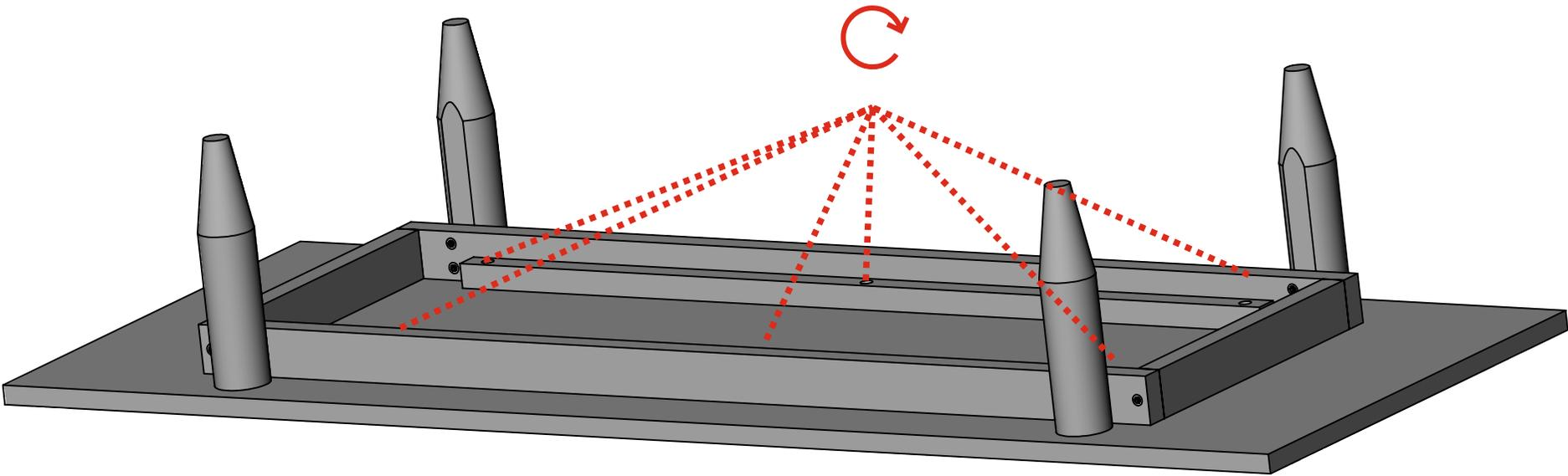
Корпус и ящики собираем на эксцентрики стяжки
