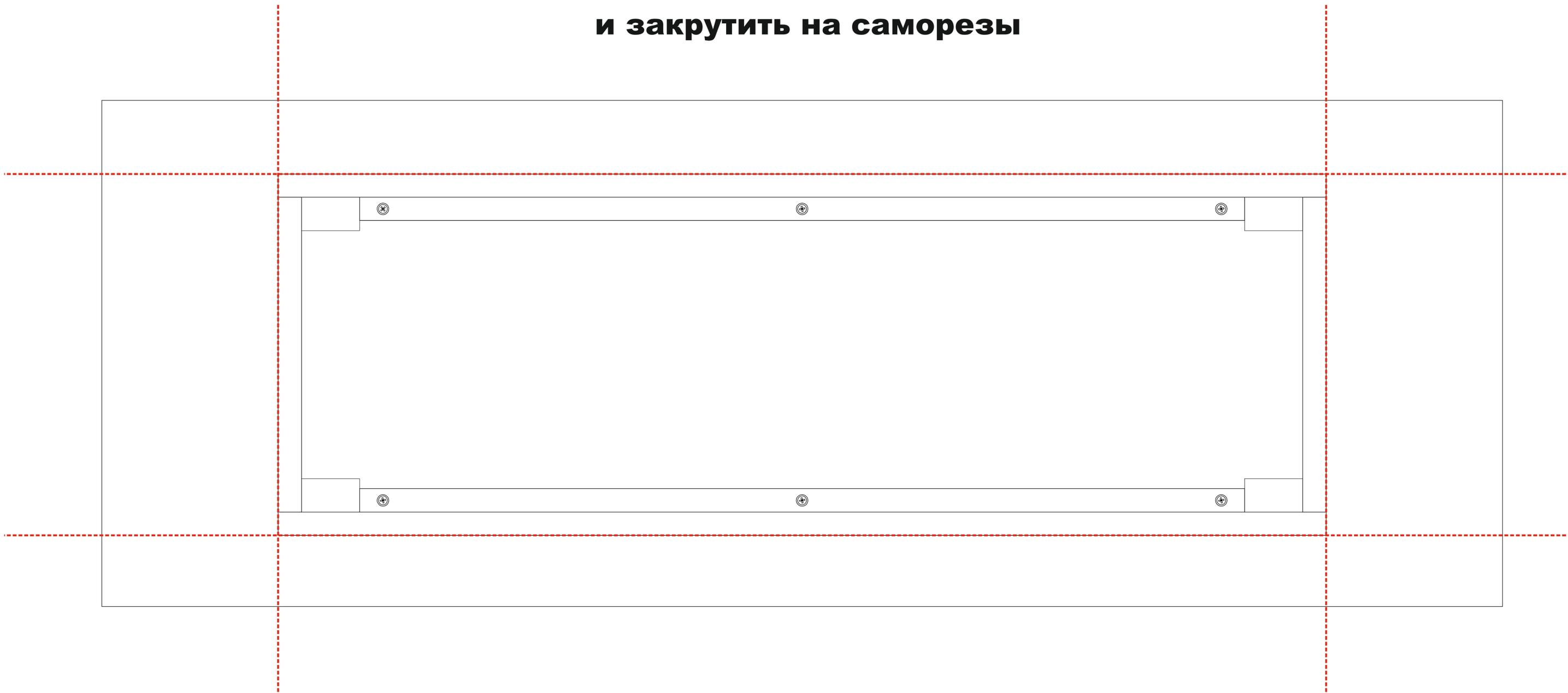
**Используйте саморезы из комплекта для фиксации каркаса ног на нижней детали корпуса .**
