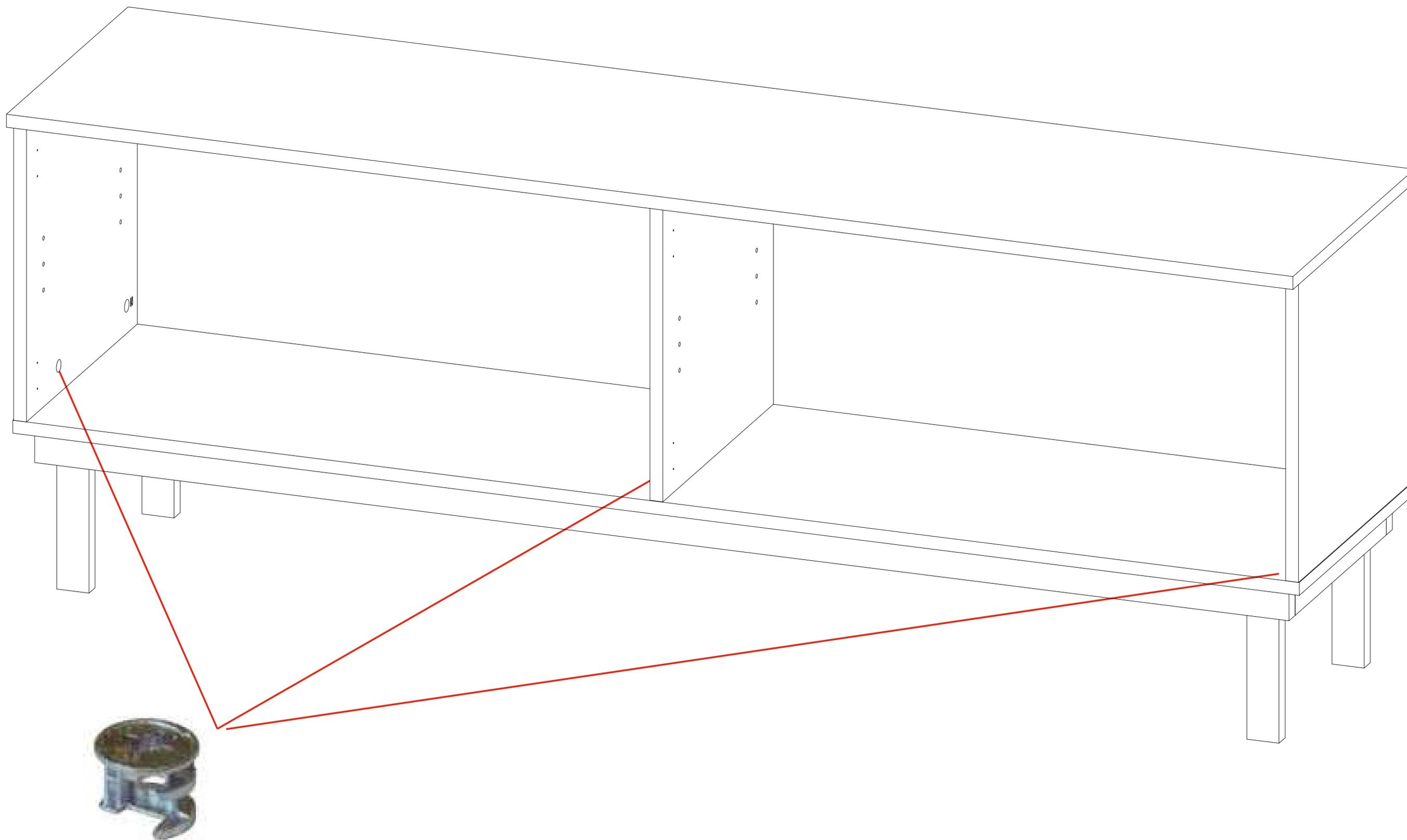
При соединении корпуса необходимо повернуть бочонок эксцентрика для стяжки компонентов
